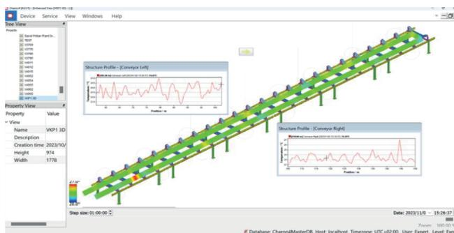
Al desgastarse, los rodamientos vibran y transmiten las vibraciones a través del bastidor del transportador y al cable. Estas vibraciones provocan cambios microscópicos en la luz retrodispersada. El sistema **LUNA EX.TRACT (DAS)** procesa estos datos, genera información online que alerta a los operadores sobre posibles fallos en cada una de las zonas configuradas.
