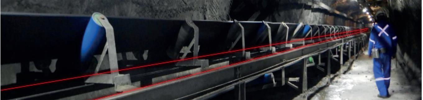
El sistema **LUNA EX.TRACT** transmite impulsos láser a través de un cable de fibra óptica instalado previamente a lo largo de la cinta transportadora.
